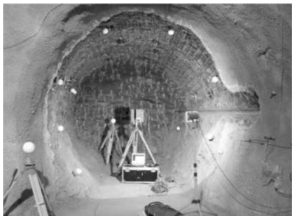
Hình 5. Thu thập dữ liệu trong hầm bằng công nghệ đo laser tĩnh (Wang et al., 2014).
